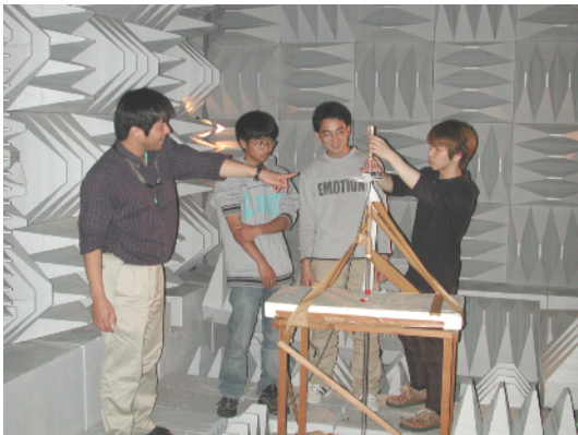
電波の反射がない電波無響室でのアンテナ実験の風景
